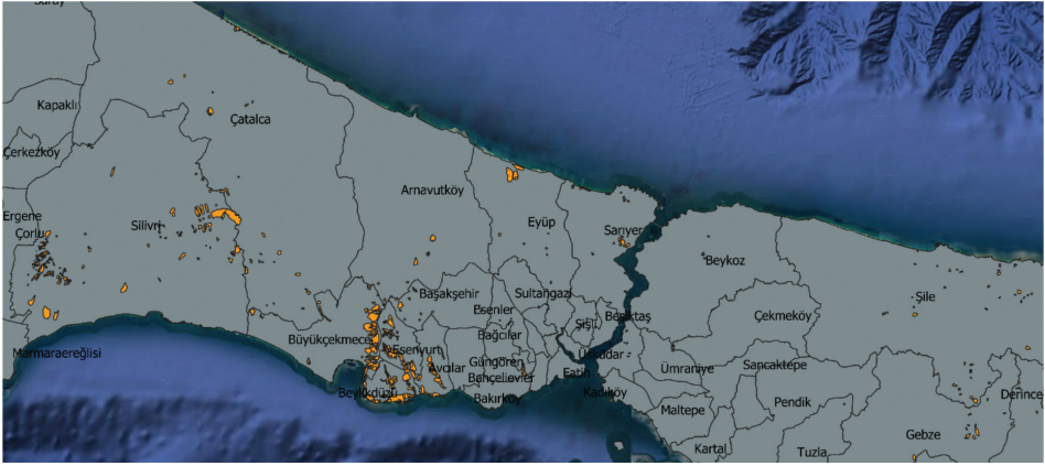
Şekil 4.22: İstanbul il genelinde tespit edilmiş olan heyelan alanları (Gedik ve diğ., 2005’den uyarlanmıştır).
